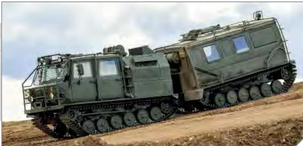
Плавающий двухзвенный транспортер-тягач 3344-20 и его модификации предназначены для транспортирования личного состава с полным арктическим снаряжением и табельным стрелковым оружием, военно-технического имущества, военных грузов, монтажа различного вооружения, медицинского и другого специального оборудования, буксировки артиллерийских систем и прицепов в боевых подразделениях и подразделениях боевого, материально-технического и медицинского
