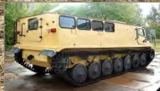
**Плавающий гусеничный снегоболотоход 5901 является новейшей разработкой конструкторов компании. Машина способна перевозить грузы массой до 5 тонн, сохраняя при этом возможность преодоления водных преград вплавь. Полная масса машины составляет 16 тонн. С полной нагрузкой снегоболотоход 5901 способен преодолевать снежную целину с глубоким снежным покровом, заболоченные участки местности, песчаные барханы, а также открытые водные пространства.**
