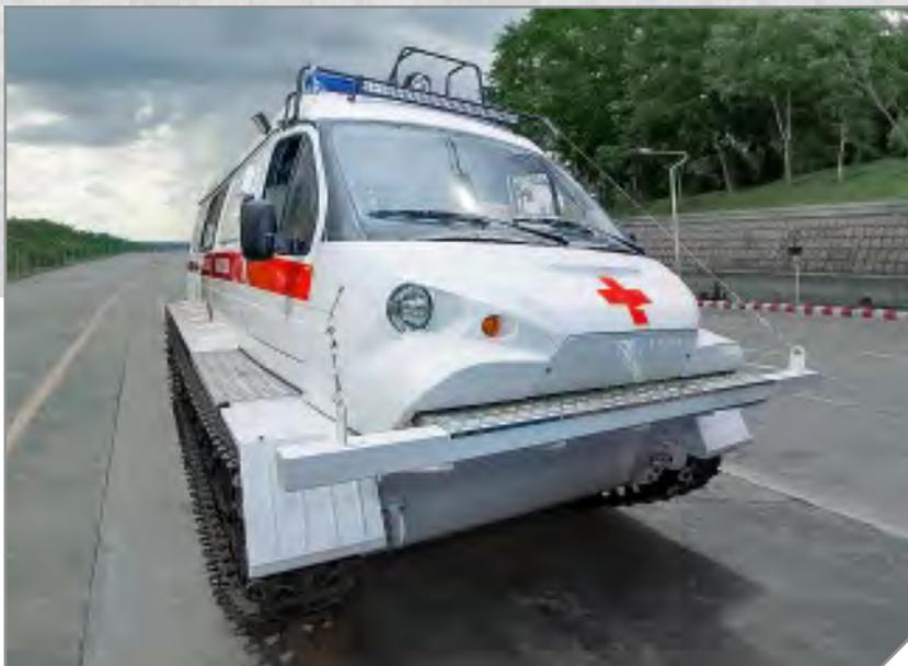
На снегоболотоход ГАЗ-34039 «Ирбис» установлен дизельный двигатель Д245.7Е2, развивающий максимальную мощность 122 л.с. Двигатель соединен с механической коробкой переключения передач. Низкое среднее удельное давление на грунт (не более 0,22 кг/см<sup>2</sup>) в совокупности с клиренсом в 400 мм обеспечивает высокую опорную проходимость машины в самых сложных условиях местности и на грунтах со слабой несущей способностью.
