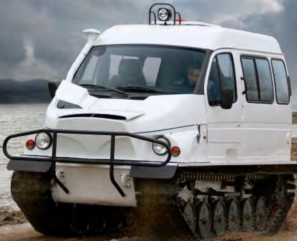
**Гусеничный плавающий снегоболотоход ГАЗ-3409 «Бобр» представляет собой универсальное транспортное средство, предназначенное для перевозки людей, грузов и спецоборудования, как по дорогам общего пользования, так и вне их по пересеченной местности, а также способен преодолевать водные преграды.**
